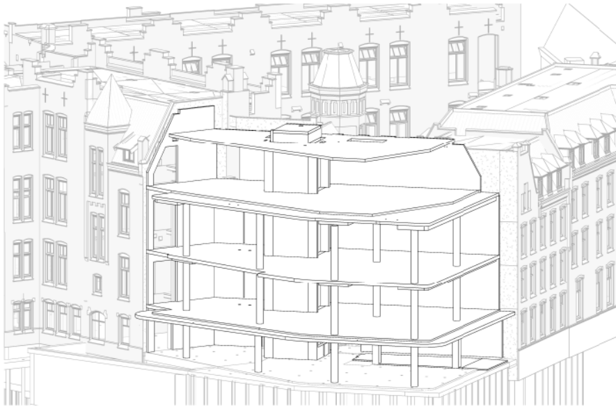
Figuur 1: Betoncasco op de positie waar de nieuwbouw komt
